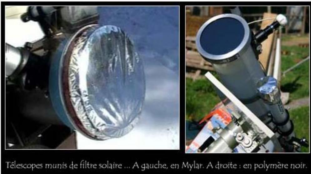
Télescopes munis de filtre solaire ... A gauche, en Mylar. A droite : en polymère noir.
